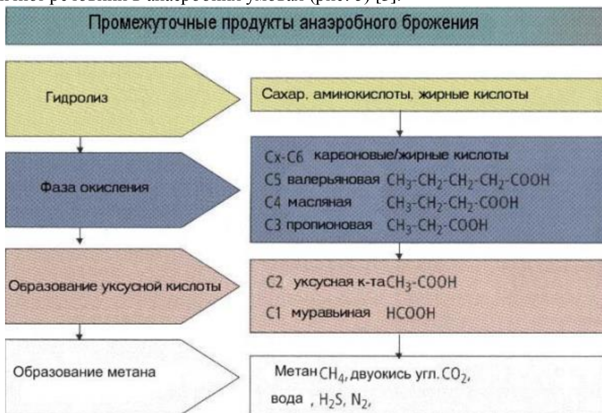
Рис. 5 – Спрощена схема анаеробного процесу збродження
