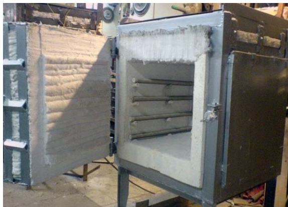
Рисунок 7.3 – Електрична піч для випалювання кераміки
