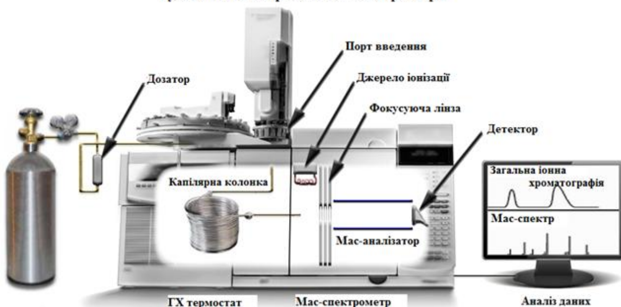
Будова газового хромато-мас-спектрометра
