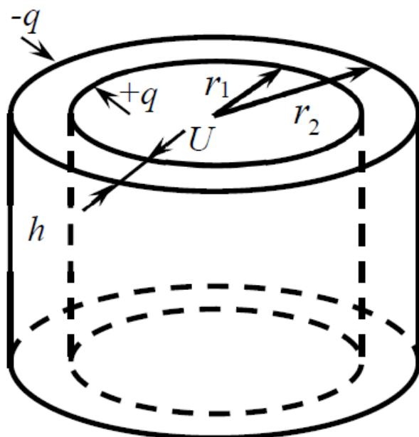
Отримаємо вираз для ємності циліндричного конденсатора:
