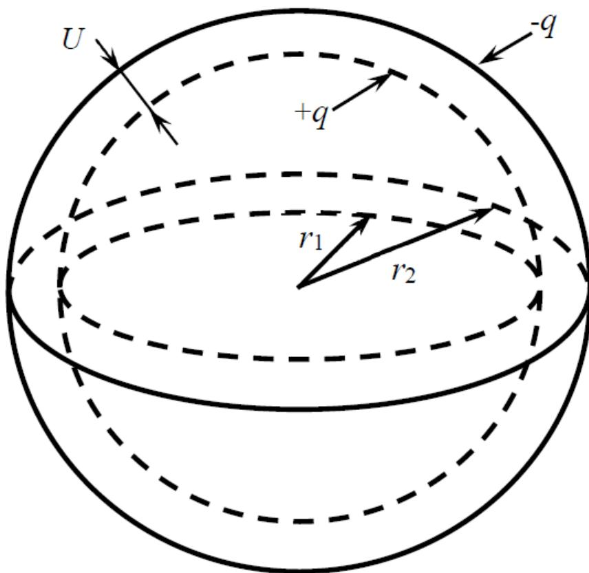
де  $q$  – заряд сфери. За межами конденсатора, коли  $r < r_1$  та  $r > r_2$  напруженість електричного поля відсутня,  $E = 0$ .
