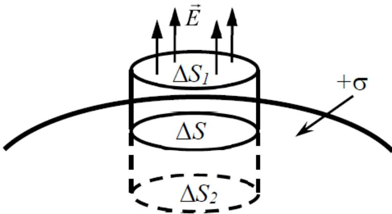
Всередині провідника  $E = 0$ , тому потік через частину поверхні циліндра, що знаходиться в провіднику, дорівнює нулю. Бічна частина циліндра, що знаходиться зовні провідника, паралельна силовим лініям  $E$ .
