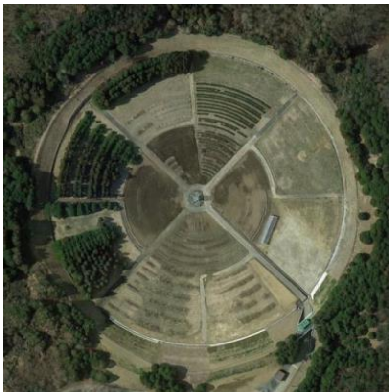
Рис. 4. Загальний вигляд гама-поля: У центрі в сталевому циліндрі знаходиться джерело випромінювання ^{60}\text{Co} (кобальтова пушка) Гама-поле в Ібаракі, Японія. Фото надано Google Earth.
