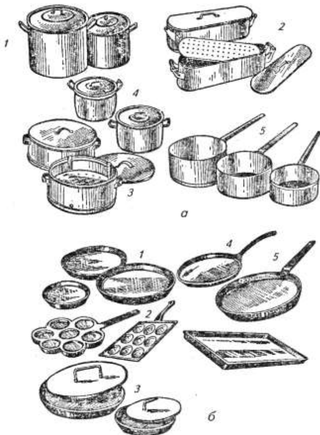
Рис. 20 — Посуда, используемая в горячем цехе: а — для варки, припускания и тушения: 1 — котлы наплитные емкостью 20—50 л; 2 — котел для варки рыбы и его составные части; 3 — котел для варки диетических блюд на пару с решеткой-вкладышем; 4 — кастрюли емкостью 2—15 л; 5 — сотейники емкостью 2—10 л; б — для жаренья: 1 — сковороды общего назначения чугунные диаметром 140—500 мм; 2 — сковороды для жаренья яиц в ячейках; 3 — сковороды с прессом для жаренья цыплят-табака; 4 — сковороды с ручкой стальные; 5 — сковороды для жаренья блинов чугунные; 6 — противни для жаренья порционных изделий
