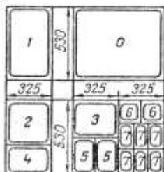
Рис. 3 – Контейнеры типа «Гастроном»: а — общий вид, б — разные исполнения, в — размеры тары «Гастроном»: 1 — контейнеры с функциональными емкостями, 2 — передвижные стеллажи с емкостями
