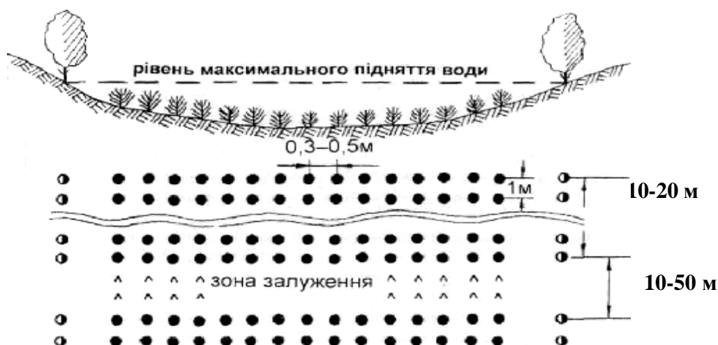
Рис. 6.6. Схема кольматувального насадження (мулофільтру)
