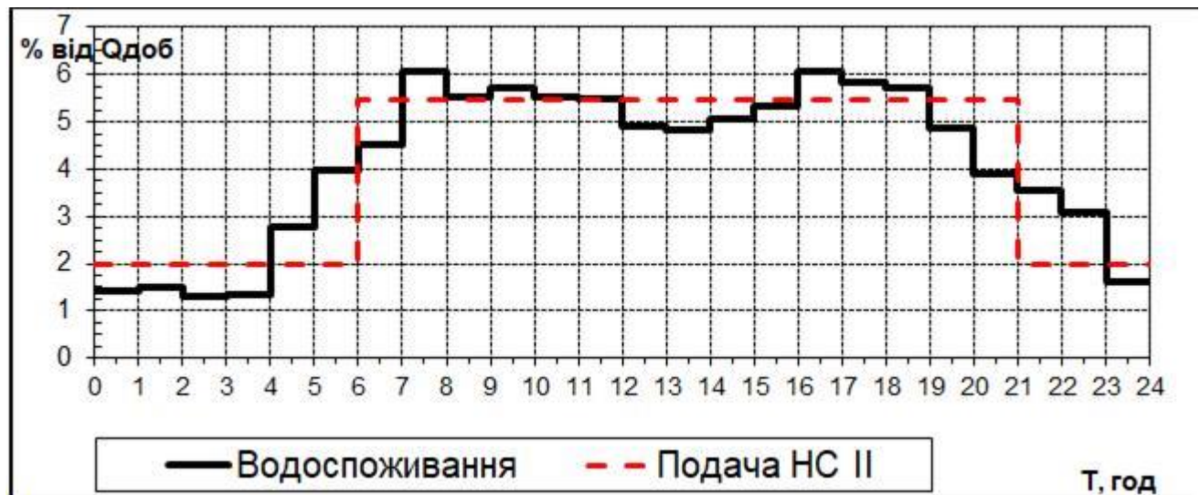
Рисунок 5.1.1 – Графік роботи насосної станції та водоспоживання міста
