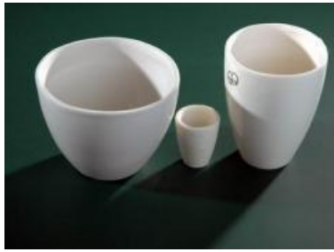
Рис. 37. Фарфорові тиглі та кухлі: а – тигелі Гуча; б – кухль; в – «ЧОВНИК».
