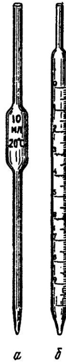
Рис. 12. Скляні піпетки: а – піпетка Мора; б – градуйована піпетка.
