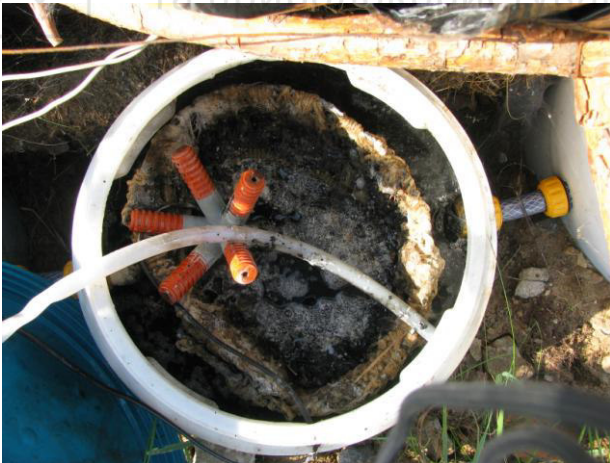
Рис. 1. Фото анаеробного біореактора під час монтажу (зверху) і після досліджень (внизу)
