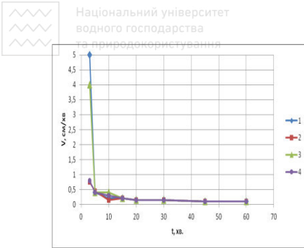
Рис. 3.16. Залежність швидкості підйому межі поділу фаз ( V ) від тривалості флоатації ( t ) модельних суспензій при P_{нас} = 0,2 МПа, t_{нас} = 4 хв. і початкових концентрацій активного мулу, г/дм 3 :
