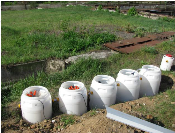
Рис. 3. Фото анаеробного біореактора під час гідравлічного випробування (зверху) і загальний вигляд експериментальної установки під час монтажу (знизу)
