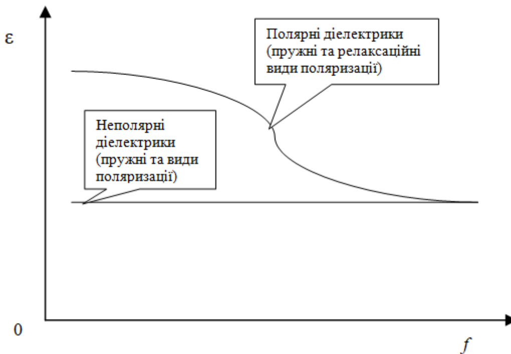
Рис.1.2. Залежність діелектричної проникності від частоти
