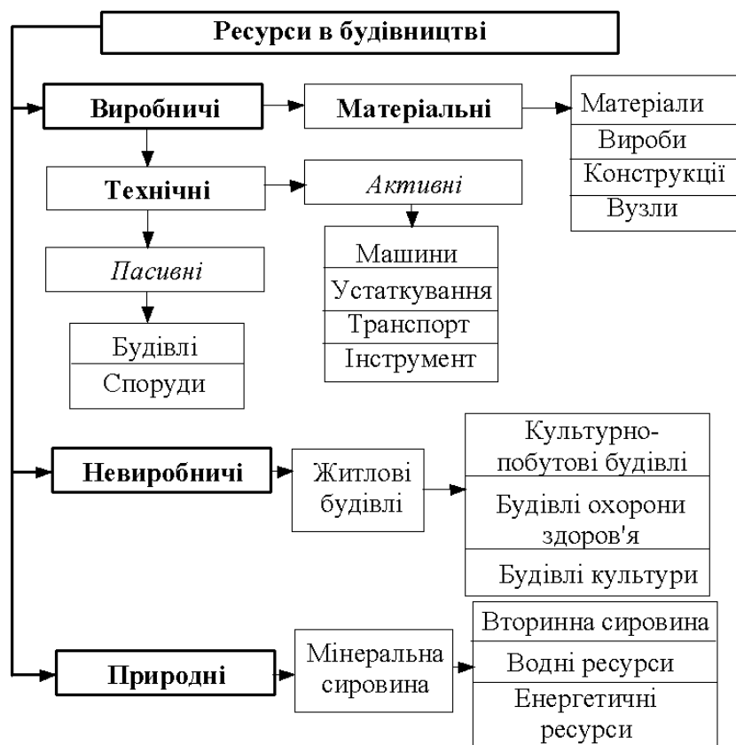
Рисунок 2.2 - Структура матеріально-технічних ресурсів будівництва
