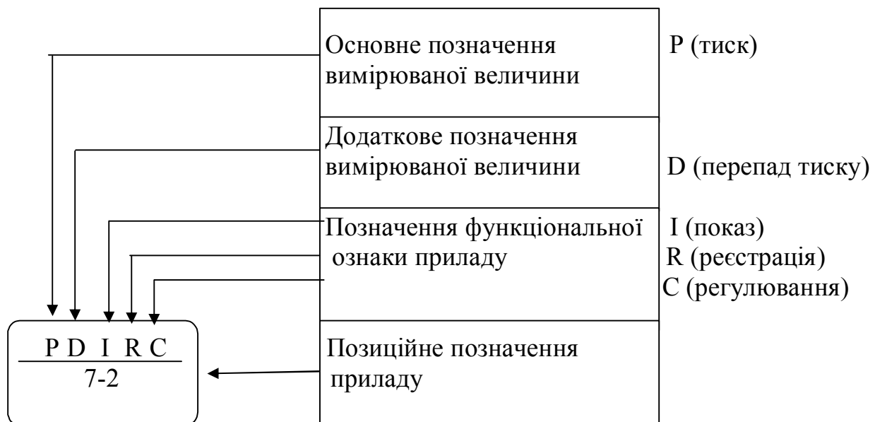
Рисунок 14.1 – Умовне зображення приладу для вимірювання, реєстрації та автоматичного регулювання перепаду тиску
