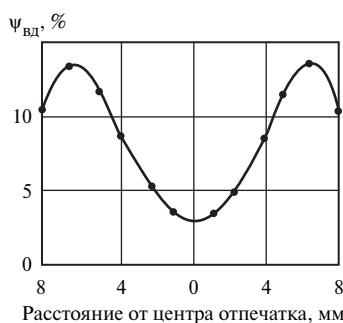
Рис. 4.23. Распределение пластической деформации по поверхности восстановленного отпечатка ( $D = 34,85$  мм;  $d/D = 0,45$ ; материал — техническое железо)
