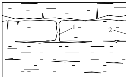
Рис. 2.8 Розповсюдження поверхневих тріщин утоми по глибині зразка сталі
