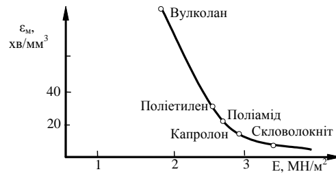
Рис. 2.23. Залежність зносостійкості полімерних матеріалів від модуля пружності
