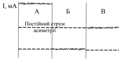
Рис. 10.6 Осцилограма струму, відповідна трьом різним режимам тертя
