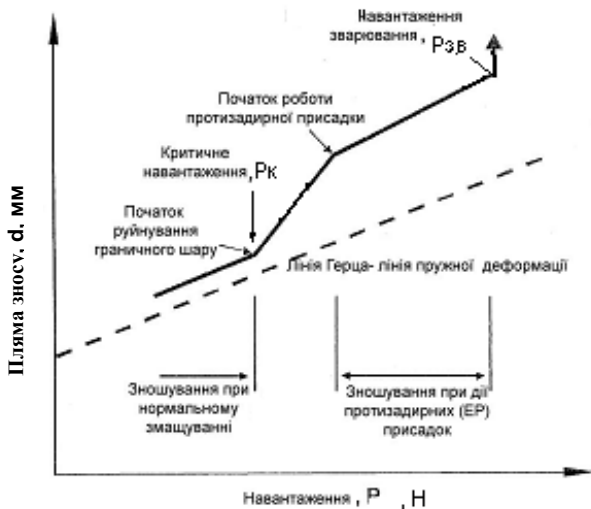
Рис.7.8 Залежність діаметру плями зносу від навантаження
