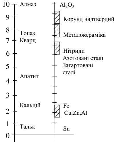
Рис. 2.27 Твердість матеріалів за шкалою Мооса
