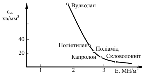
Рис. 2.30 Залежність зносостійкості полімерних матеріалів від модуля пружності
