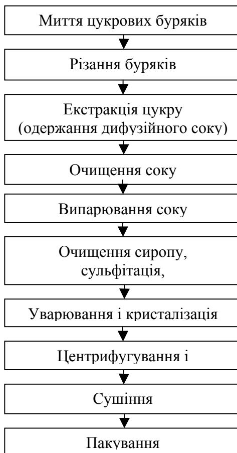
Рис. 9.2. Технологічний процес виробництва цукру
