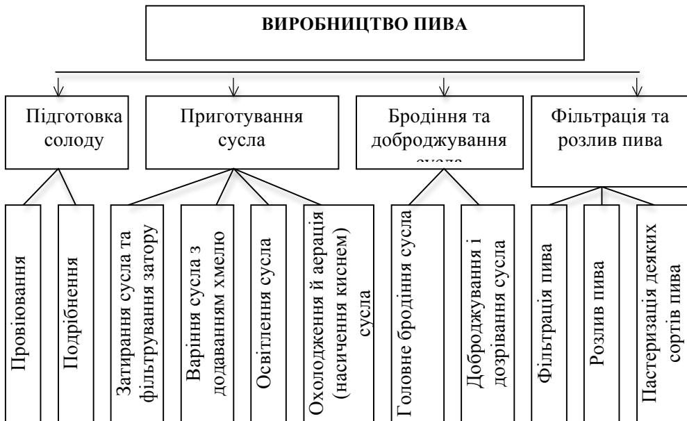
Рис. 9.10. Технологічний процес виробництва пива
