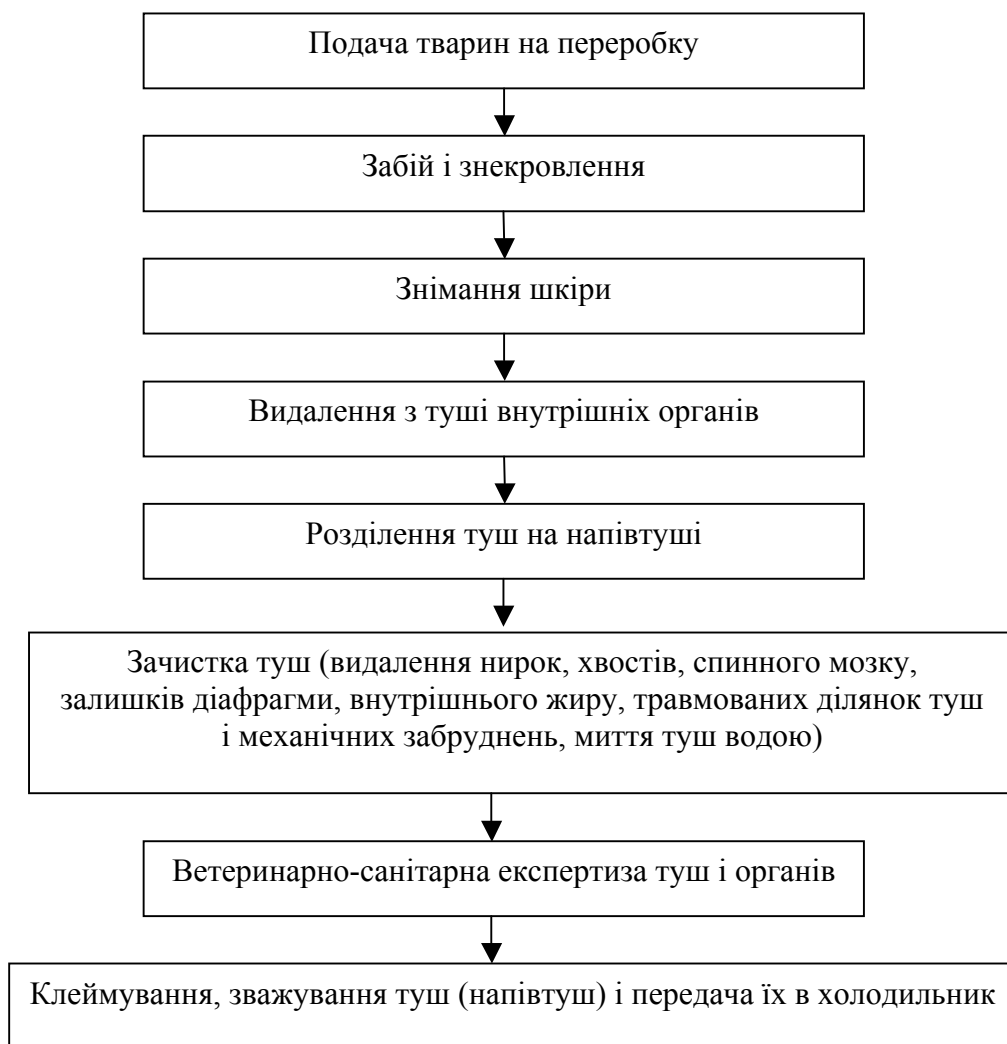
Рис. 9.14. Технологічний процес забою худоби
