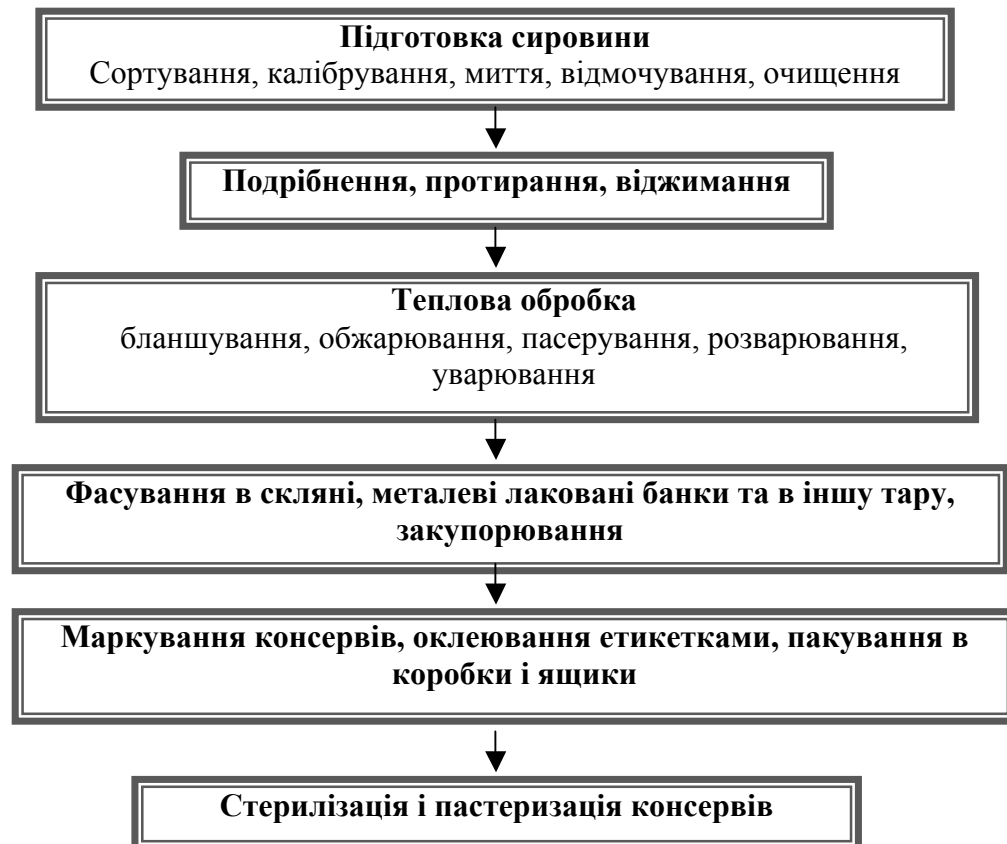
Рис. 9.13. Технологічний процес виробництва плодоовочевих консервів
