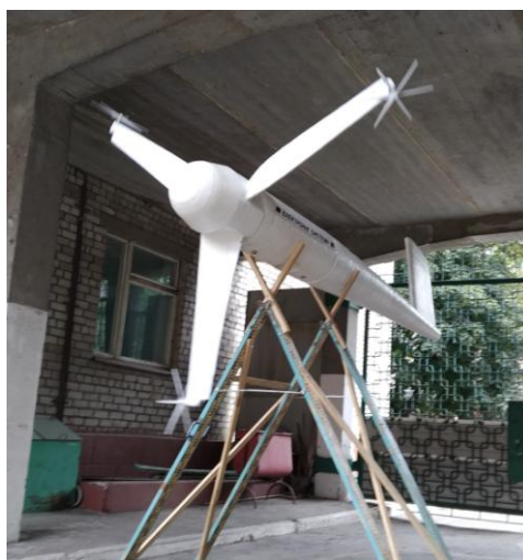
Експериментальна вітроенергетична установка «Електронні системи» для дослідження електромеханічних процесів у ВЕУ з аеродинамічним мультиплікуванням
