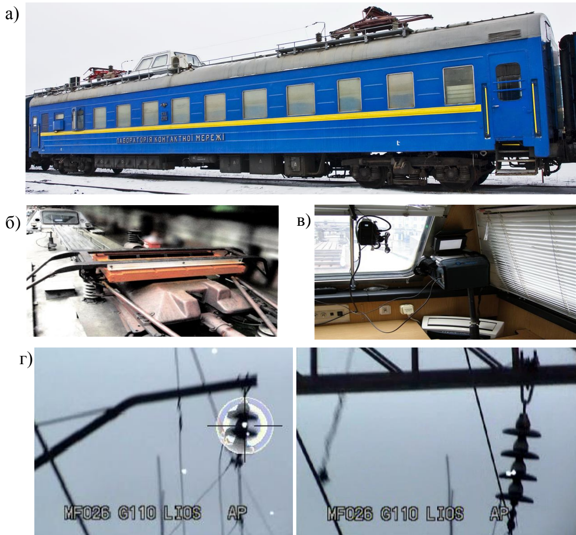
Рисунок 5.11 – ВВКМ: зовнішній вигляд (а); датчик зносу контактного проводу (б); камери: відеоспостереження та ультрафіолетова DayCorII (в); дефектні ізолятори КМ виявлені за допомогою камери DayCorII (г)
