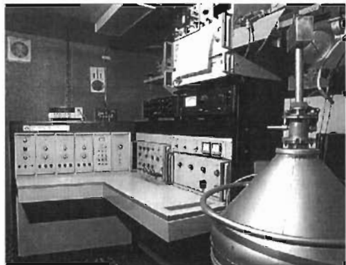
Рис. 39. Государственный первичный эталон единицы электрического напряжения
