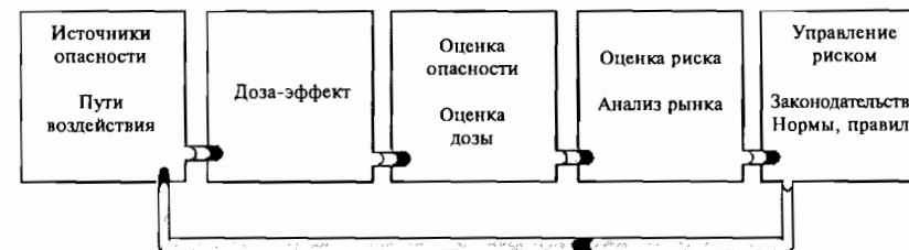
Рис. 71. Логическая схема этапов оценки и анализа риска, создаваемого нанобъектами для человека и окружающей среды
