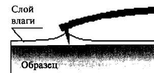
Рис. 46. Схема возникновения капиллярной силы
