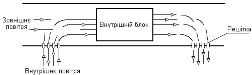
Рис. 13.8. Схема каналного кондиціонера
