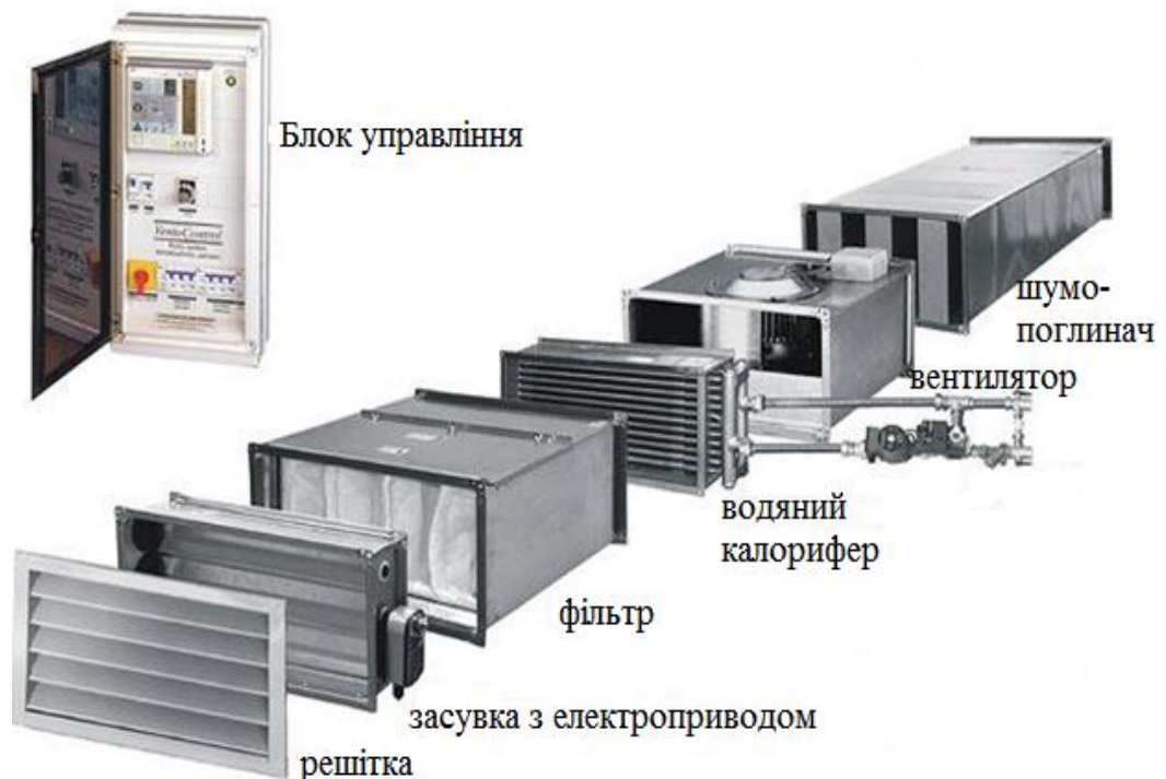
Рис. 10.30. Елементи набірної припливної камери
