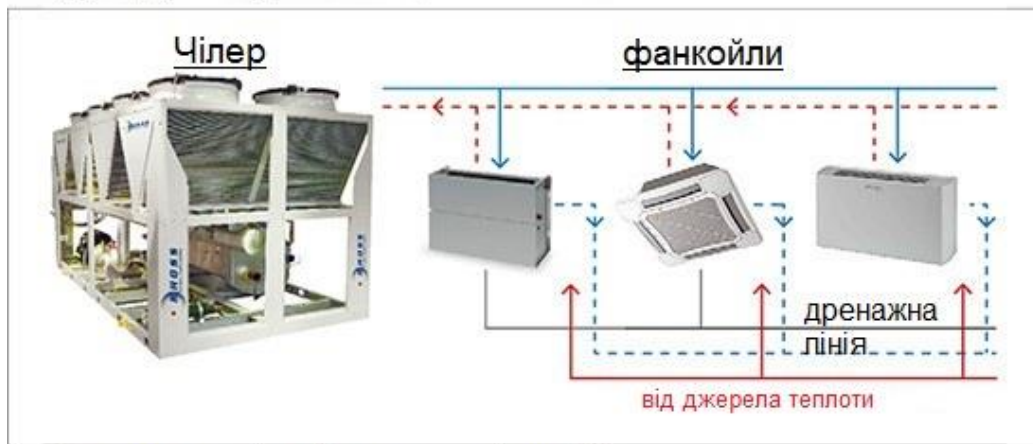
б) чотирьохтрубне підключення фанкойлів
