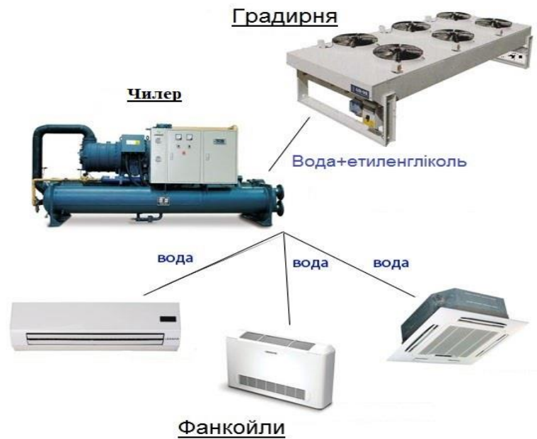
Рис. 13.9. Неавтономна система кондиціювання чилер-фанкойл
