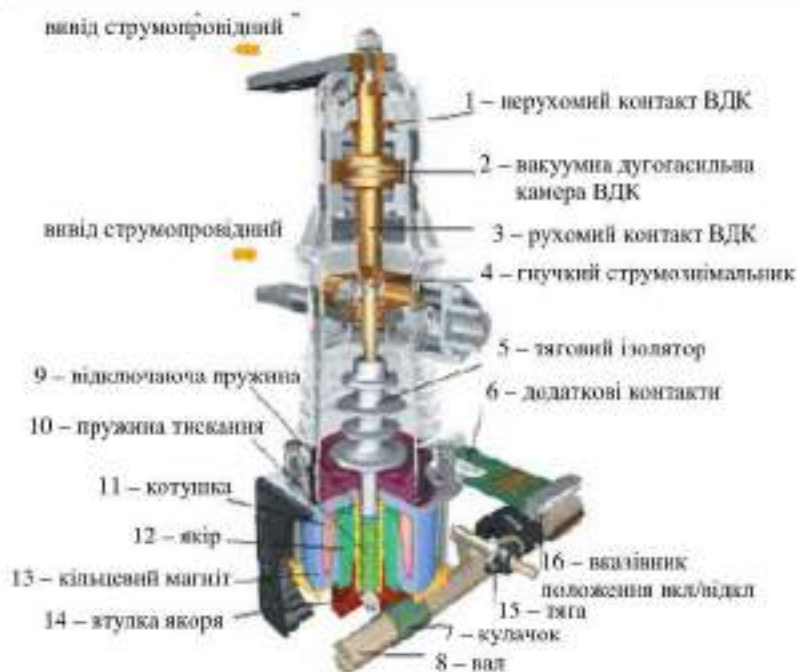
Рисунок 8.6 – Конструкція вакуумного вимикача серії ВВ/TEL-10
