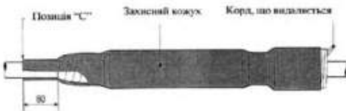
Рисунок 7.15 – Монтаж кабельної муфти, етап восьмий
