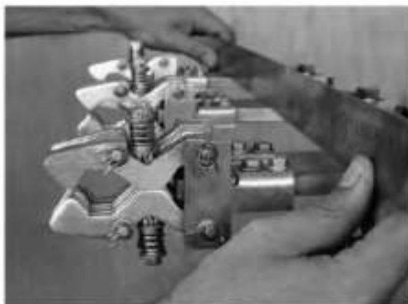
Рисунок 8.18 – Настроювання положення по горизонталі верхніх ШПК
