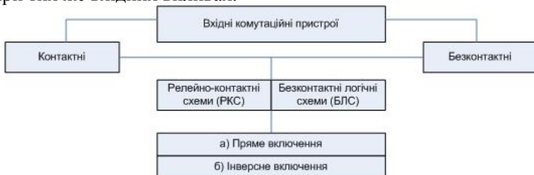
Рисунок 4.14 – Схеми включення вхідних пристроїв у АСК
