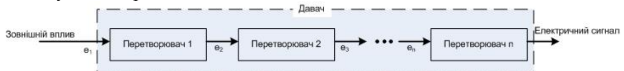
Рисунок 4.1 – Датчик може складатись з кількох перетворювачів, E_1 , E_2 , E_3 – різні види енергії (останній елемент даної системи є датчиком прямої дії)
