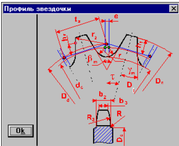
Рисунок 52 – Вікно результатів: Профіль зубів зірочки
