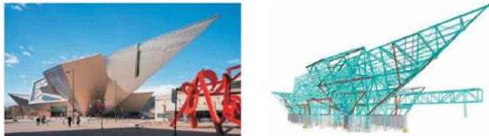
Рис. 4. BIM сталевого каркасу та фасад Музею мистецтв у Денвері, США, арх. бюро D. Libeskind, 2006 р.
