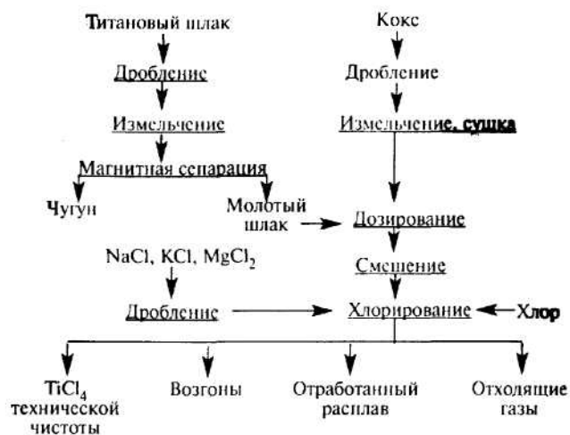
Рис. 6.1. Технологическая схема хлорирования титанового шлака в расплавленном хлораторе
