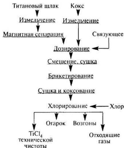
Рис. 6.2. Технологическая схема хлорирования титанового шлака в шахтном хлораторе
