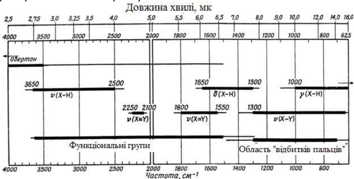
Рис. 8. Ділянка основних коливань в ІЧ-спектрі: \nu – валентні, \delta – деформаційні (площинні), \gamma – деформаційні (позаплощинні) коливання; X і Y позначають C і N (або O ) відповідно. Ділянки поглинання найбільш важливих коливань показано жирними лініями. Тонкі лінії вказують ділянки, де поглинання, що відповідає даному коливанню, трапляється рідко.
