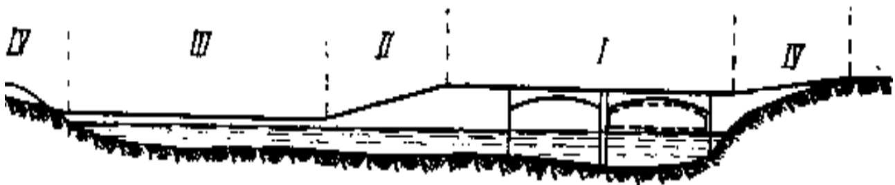
Рисунок 3.9 – Характерні ділянки мостового переходу через широку річку
