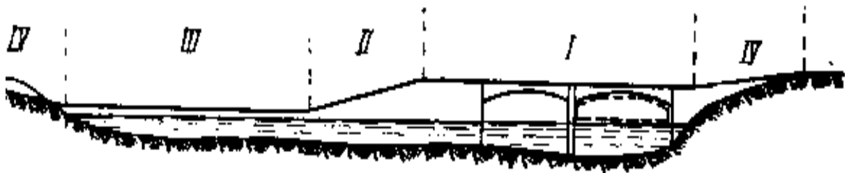
Рис. 10. Ділянки мостового переходу через широку річку.
