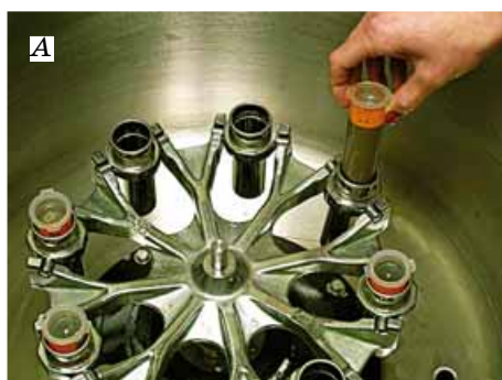
Мал. 42. А. Центрифуга. Б. Метод центрифугування: послідовні стадії осідання структур клітини залежно від їхньої маси
