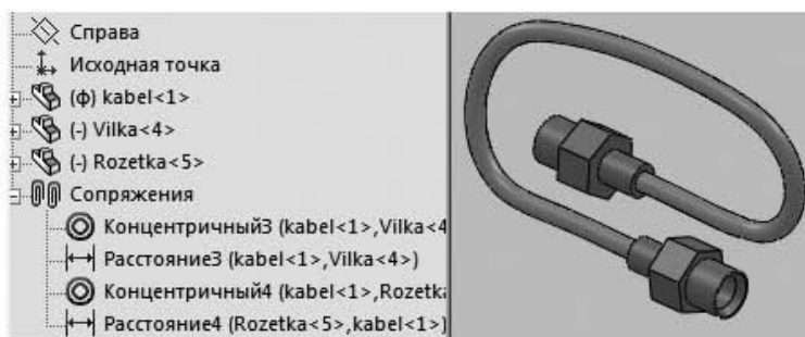
Рис. 6.59. Сопряжение компонентов кабеля, вилки, розетки
