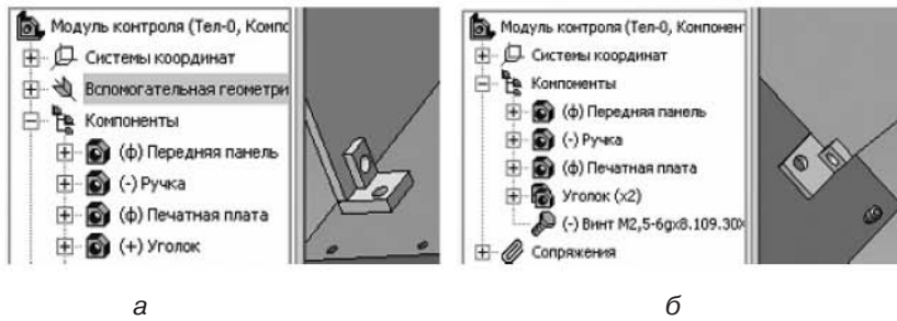
Рис. 3.53. Расположение в сборке уголков: а — сверху печатной платы; б — внизу печатной платы
