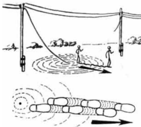
Рис. 12.2. Дії особи (зменшення крокової напруги) при її потраплянні в зону впливу електричного струму
