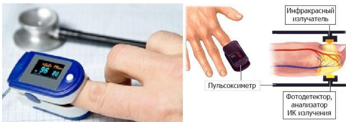
Рис. 21. Метод пульсоксиметрії: застосування та механізм дії
