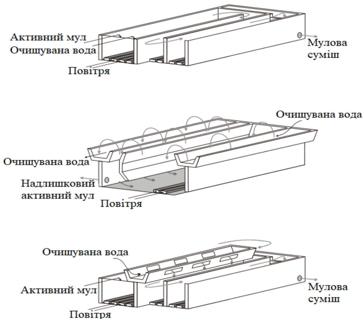
Рисунок 5.1 – Схеми аеротенків, зверху вниз: аеротенк витіснення, аеротенк змішування, аеротенк із розосередженим поданням стічної води та регенерацією активного мулу (Волова Т.Г., 1999)
