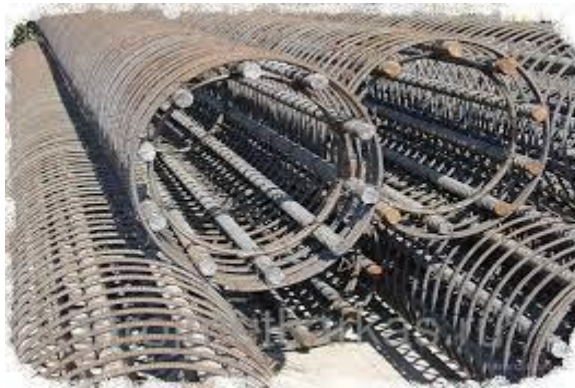
Рисунок 3.10 - Арматурні каркаси для глибоких бурових опор: а - з фіксувальними коротунами; б-зі спрямовуючими кутиками; 1 - стрижні поздовжньої арматури
