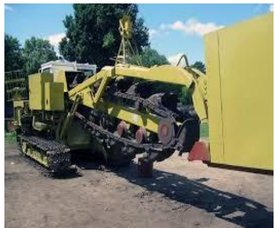
Рисунок 3.16 - Грейферний та багатоковшевий екскаватор
