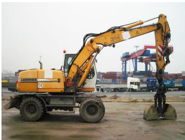
Рисунок 3.16 - Грейферний та багатоковшевий екскаватор
