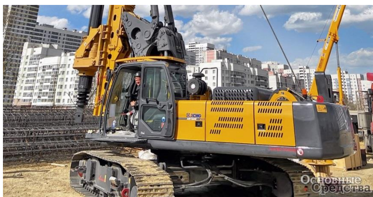
Рисунок 3.2 - XCMG бурове обладнання з Китаю (роторна бурова уніфікована машина с грейфером)
