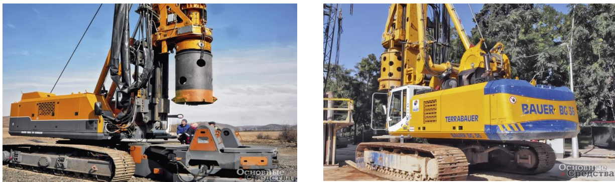
Рисунок 3.4 – Бурова установка Bauer MBG24 з обсадним столом CO-1500-03 виробництва PTC ERDE TOOLS
