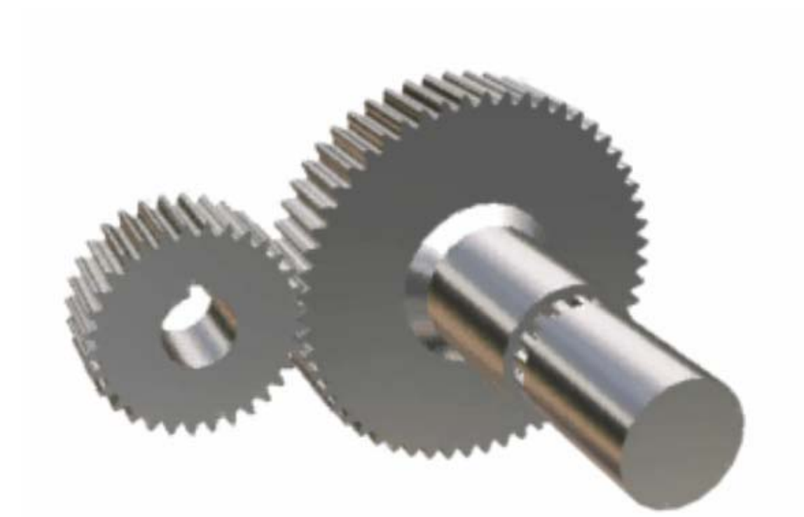
Рисунок 27 – Зубчатая передача со шлицевым соединением в сборе
