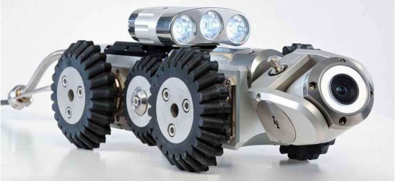
Рисунок 4.6 – Телевізійна камера для діагностики каналізаційних мереж
