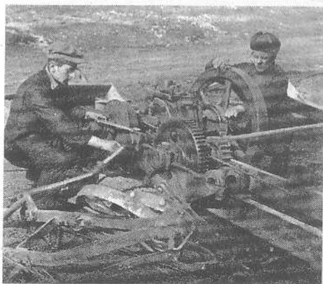
Зборка трактора «Запорожець»
