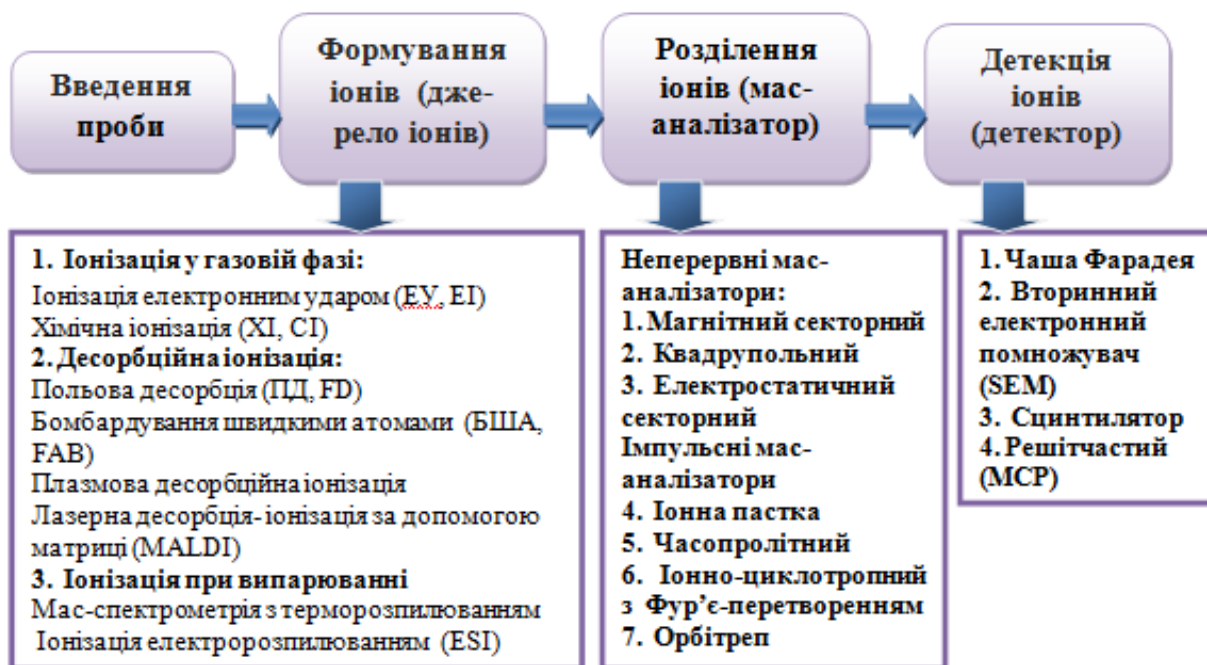
Блок-схема типового мас-спектрометра
