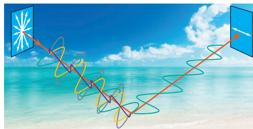
Рис. 32.5. Якщо світло падає на поверхню води під кутом, що дорівнює куту Брюстера, відбите світло буде повністю поляризованим у площині, яка перпендикулярна до площини поширення світла
