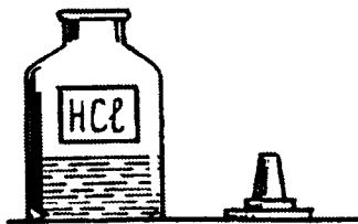
Мал. 2. Так треба ставити пробку, відкривши посудину з реактивом
