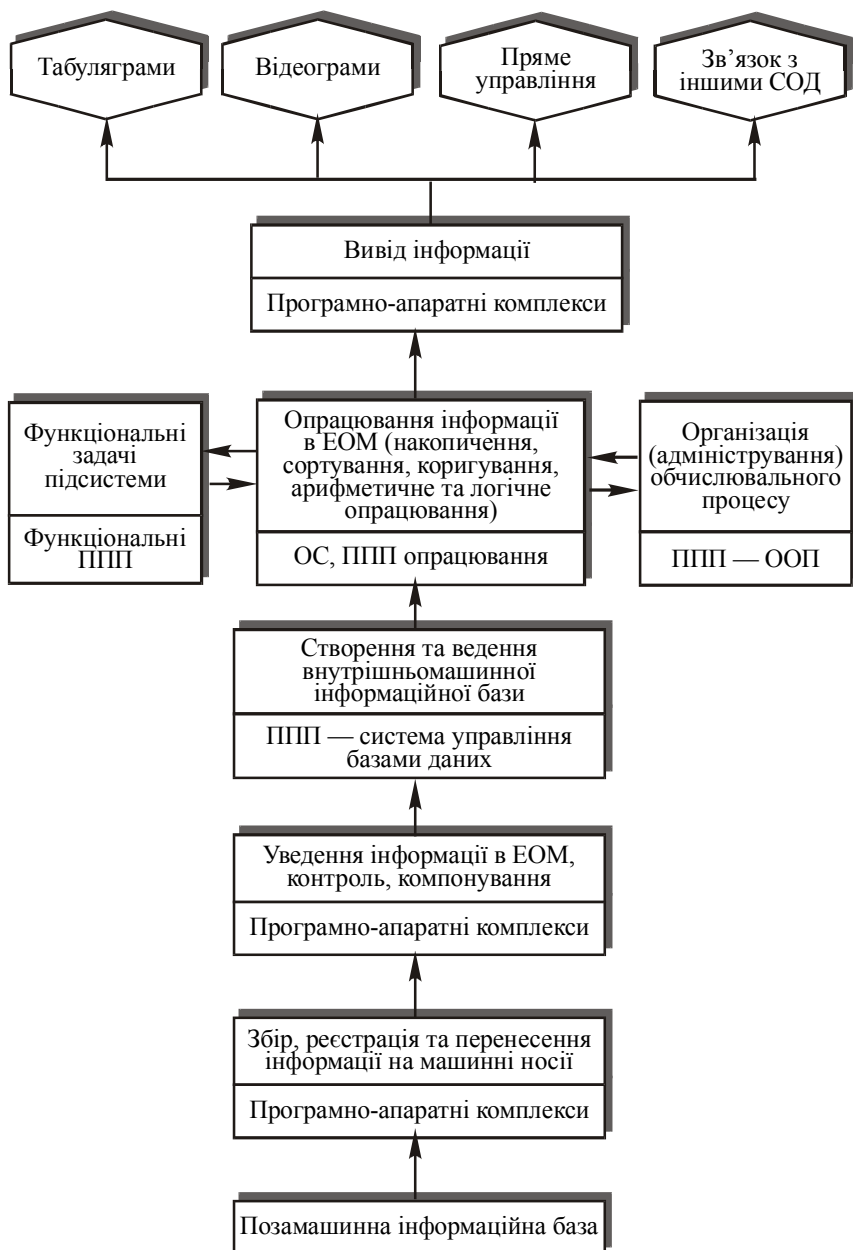
Рис. 2.3. Принципова схема системи опрацювання даних (СОД)
