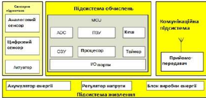
Рис. 8.13. Апаратна частина вузла сенсорної мережі
