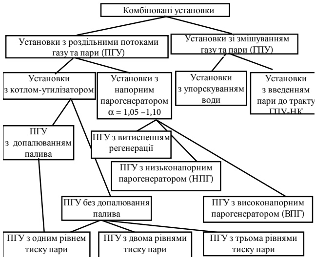
Рисунок 14.8 – Схема класифікації комбінованих установок з паровими і газовими турбінами
