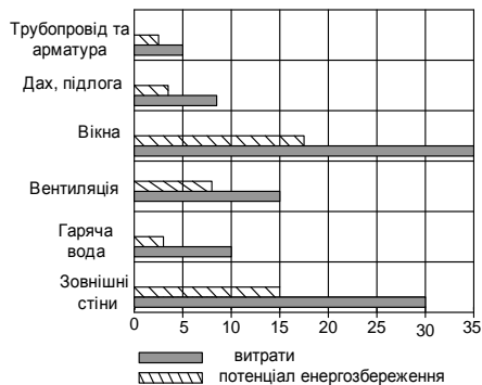
Рисунок 21.1 – Типова структура витрати теплової енергії будинком і потенціал енергозбереження.
