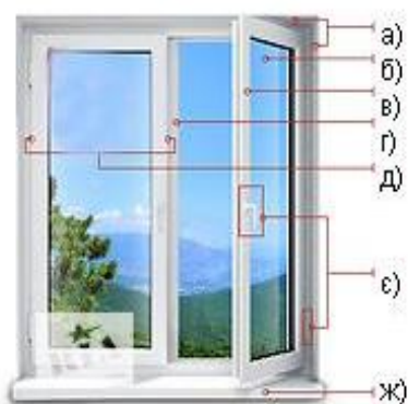
Рисунок 2.29 – Конструкції віконних блоків:
