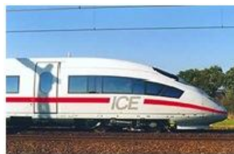
Рисунок 5.37 – Приклади моторвагонних потягів: а) із кінцевою тягою (ICE2 «Thalys», Франція); б) із розподіленою тягою (ICE3, Німеччина)
