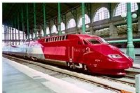
Рисунок 5.37 – Приклади моторвагонних потягів: а) із кінцевою тягою (ICE2 «Thalys», Франція); б) із розподіленою тягою (ICE3, Німеччина)
