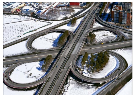
Рисунок 4.32 – Характерний приклад повної транспортної розв'язки типу «лист конюшини»
