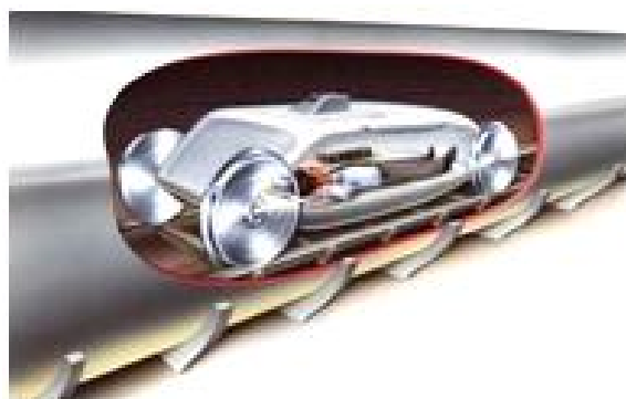
Рисунок 5.40 – Принципова конструкція пасажирського трубопроводу
