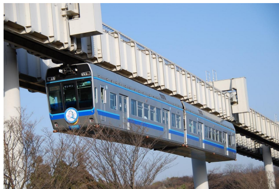
Рисунок 5.35 – Зовнішній вигляд монорельсової дороги а) навісної (м. Москва, Росія); б) підвісної (м. Осака, Японія)
