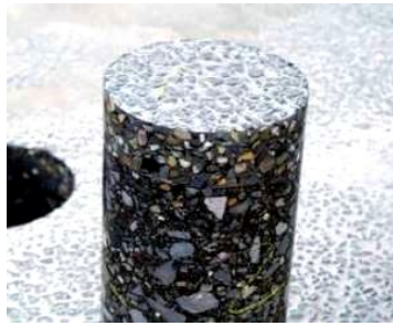
Рисунок 4.49 – Зовнішній вигляд поверхні литого асфальтобетону та керну, що вирізаний з нього
