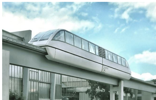
Рисунок 5.36 – Монорельс на магнітній подушці (м. Бірмінгем, Англія)
