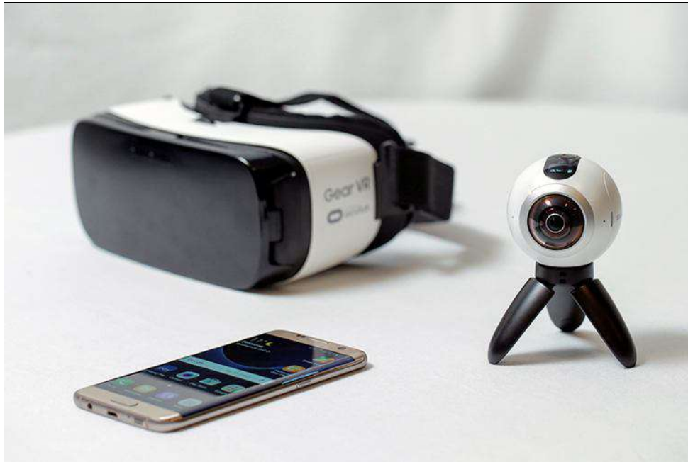
Рис. 12. Панорамна камера від Samsung, розрахована на використання разом зі смартфоном і окулярами віртуальної реальності.
