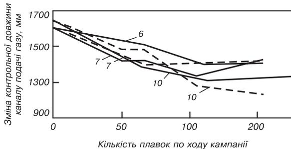
**Рис. 7.29. Швидкість зносу вогнетривких моноблоків в процесі кампанії конвертера (цифри біля кривих – в середньому за плавку, мм)**
