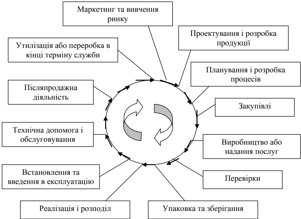
Рис. 3.7. Перелік основних процесів на основі схеми життєвого циклу продукції по ISO 9004–1:1994
