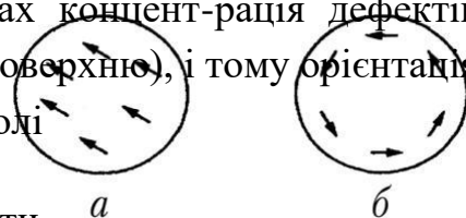
Рис. 4.34. Різна орієнтація магнітних моментів у наночастинці феромагнетика
