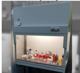
Рисунок 6. Ламінарна шафа (забезпечує рівномірний вертикальний потік стерильного повітря, захищаючи культуру клітин від мікробного зараження).
